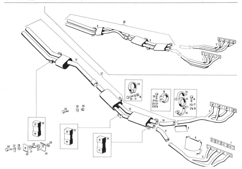
Tavola 30 - Tubi di scarico Table 30 - Exhaust pipes Tableau 30 - Conduite d'echappement Tafel 30 - Auspuff
