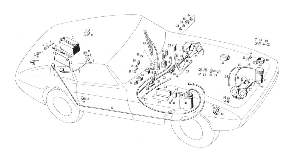
Tavola 33 - Equipaggiamento elettrico Table 33 - Electric equipment Tableau 33 - Equipment électrique Tafel 33 - Elektrische Ausrühstung
