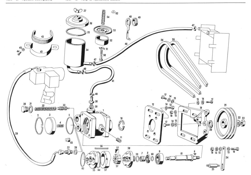
Tavola 27 - Pompa per sterzo idraulico Table 27 - Hydraulic steering pump Tableau 27 - Pompe paur direction Hydraulique Tafel 27 - Pump für Hydraulische Leukuno
