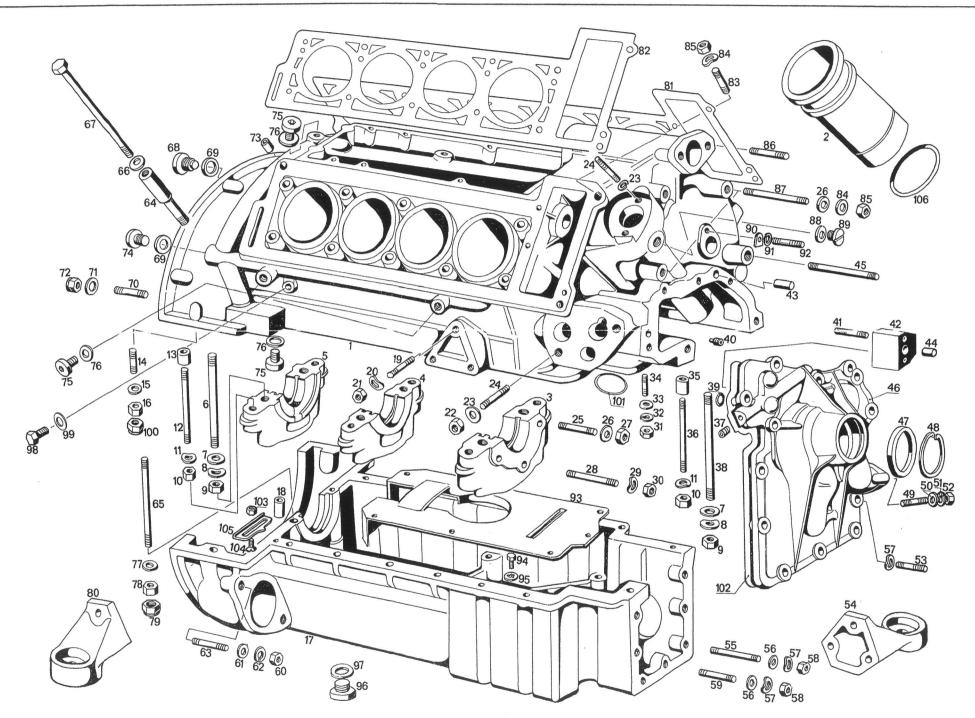
Tavola 2 - Blocco motore Table 2 - Engine housing Tableau 2 - Bloc moteur Tafel 2 - Motorgehäuse
